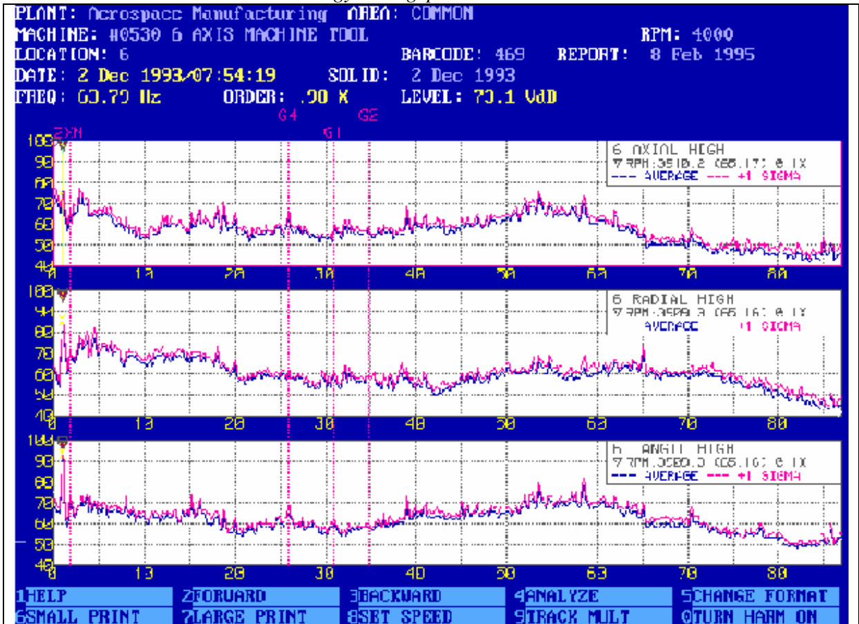
2. ábra. Egy marógép fősorcsapágy rezgésspektruma
