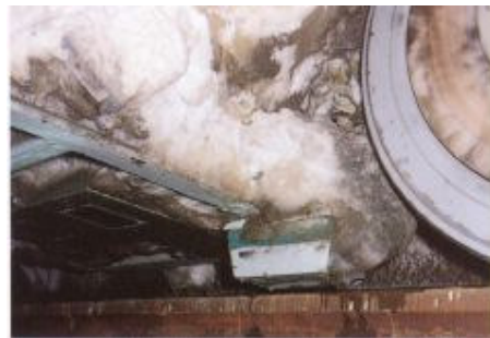
Az optikai érzékelő nem alkalmazható, mivel a hóval fedett (baloldalon), és az örvény-áramú- érezkelő, amely a hóban is teljesen ellátja feladatát.
